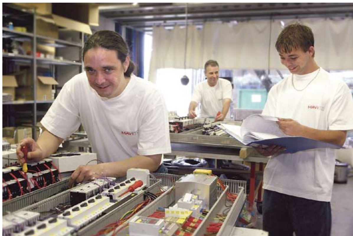
Personeel van Mavitec bouwt besturingspanelen tot wel 12 meter lang.
